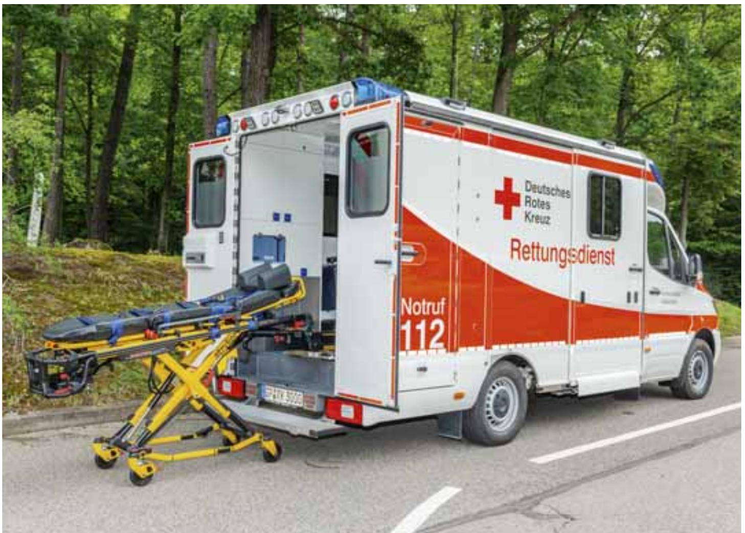
Die neuen RTW sind mit einer elektro-hydraulischen Fahrtrage ausgestattet – ein sehr wichtiger, ergonomischer Aspekt.
