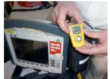
Mit einem schrillen Piepsen zeigt das CO-Warngerät eine erhöhte Konzentration von Kohlenmonoxid an.
